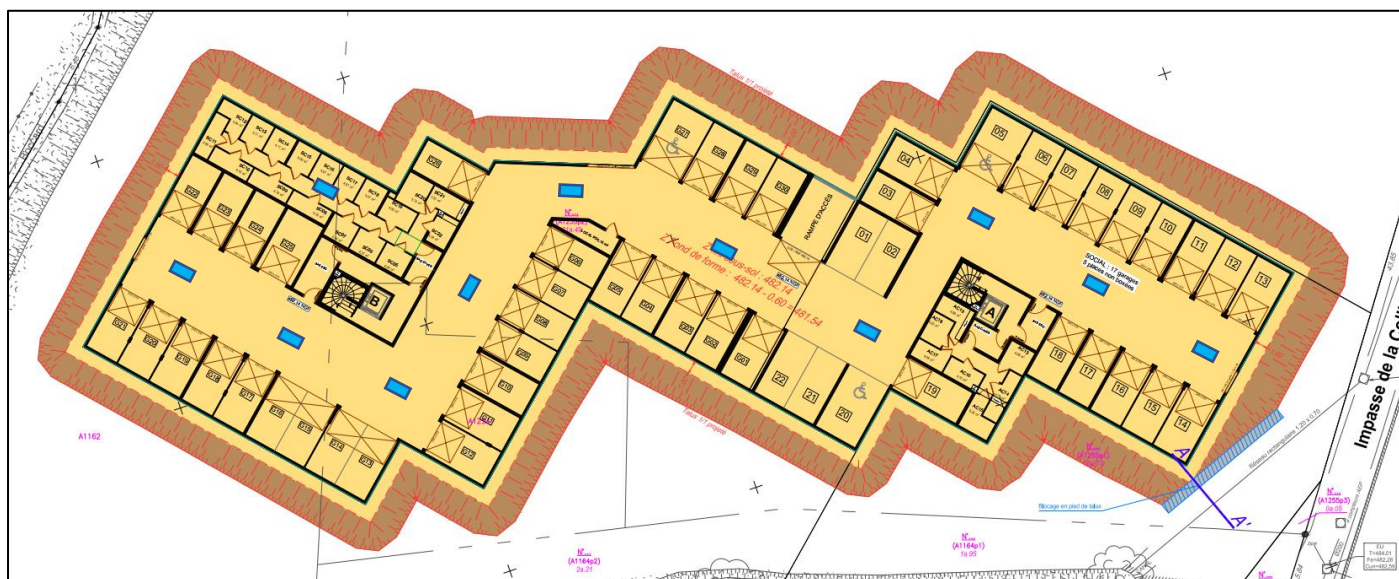
Plan de principe de l'implantation des puits de décompression
